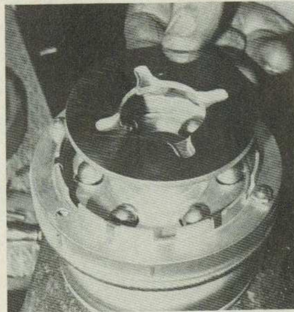
Sens de montage du plateau de pression dont la face rectifiée doit être contre le disque en garniture (Photo RMT)
