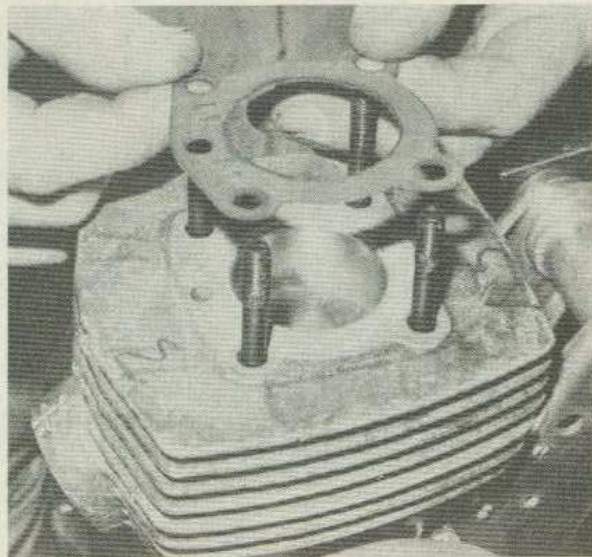
Au remontage du joint de culasse, faire correspondre son perçage avant avec l'orifice du cylindre (Photo RMT)
