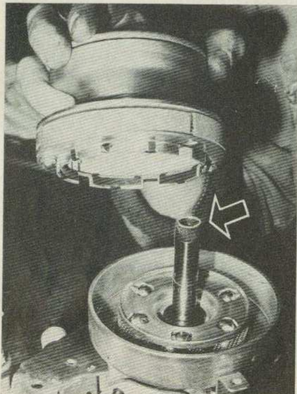
A la dépose ou la reposes de la poulie motrice, visser la douille Peugeot n° 69 142 pour maintenir le tambour d'appui des billes en bout du vilebrequin afin d'éviter aux billes de s'échapper (Photo RMT)
