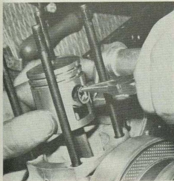
Extraction d'un circlip de l'axe de piston avec une pince fermante (Photo RMT)
