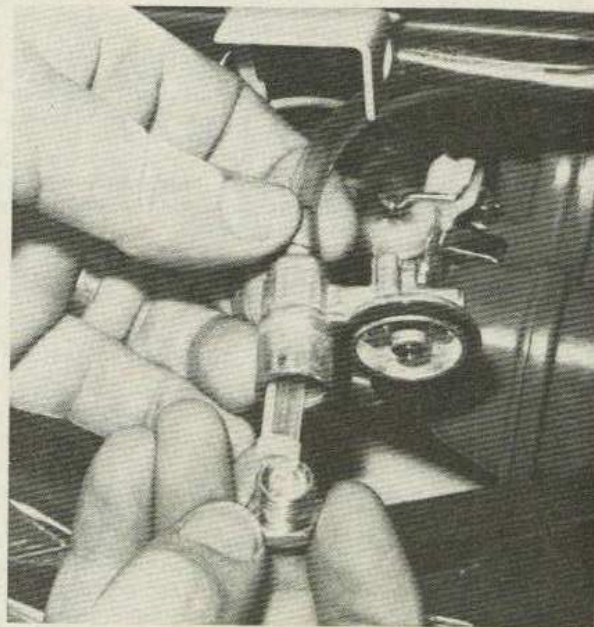
Démontage du filtre à essence au niveau du carburateur (Photo RMT)
