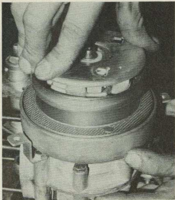
Repose de la poulie variable sur la queue du vilebrequin (Photo RMT)
