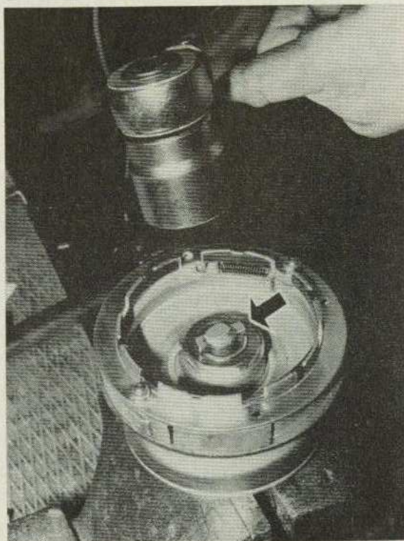
Débloccage de l'écrou de la poulie variable après avoir maintenu cette dernière avec l'outil Peugeot n° 69 259 (flèche sur la photo) qui est serré dans un étiau (Photo RMT)
