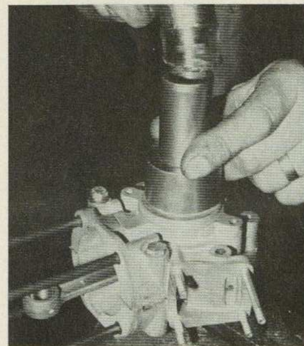
Repose du joint à lèvres gauche à l'aide d'un poussoir (Photo RMT)
