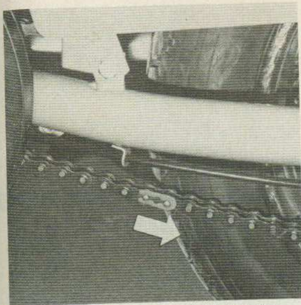
Position de montage du clip de l'attache rapide dont l'ouverture doit être à l'opposé du sens de défilement de la chaîne (Photo RMT)
