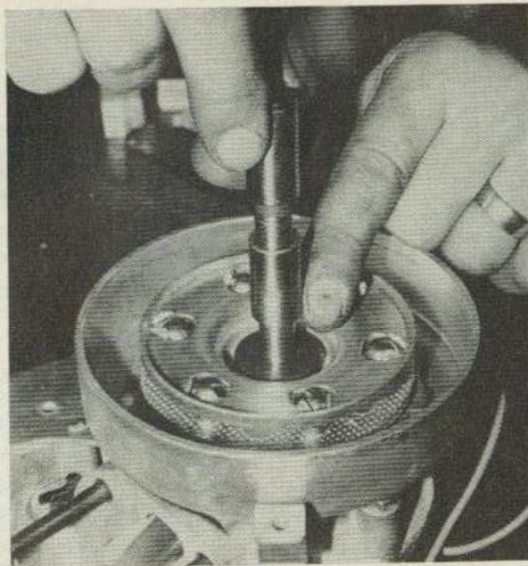
Dépose des deux entretoises sur les modèles à variateur (Photo RMT)
