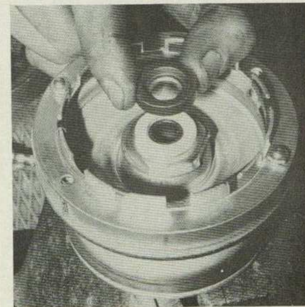
Sens de montage de la rondelle embrevée à l'empilage sur l'établi des pièces de l'embrayage à variateur (Photo RMT)
