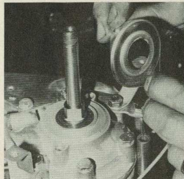
Dépose de la plaque d'arrêt du joint à lèvres gauche du vilebrequin (Photo RMT)
