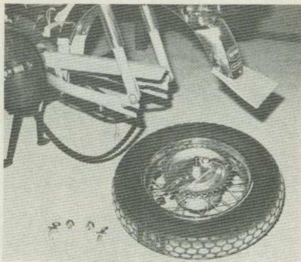
Démontage de la roue arrière (Photo RMT)
