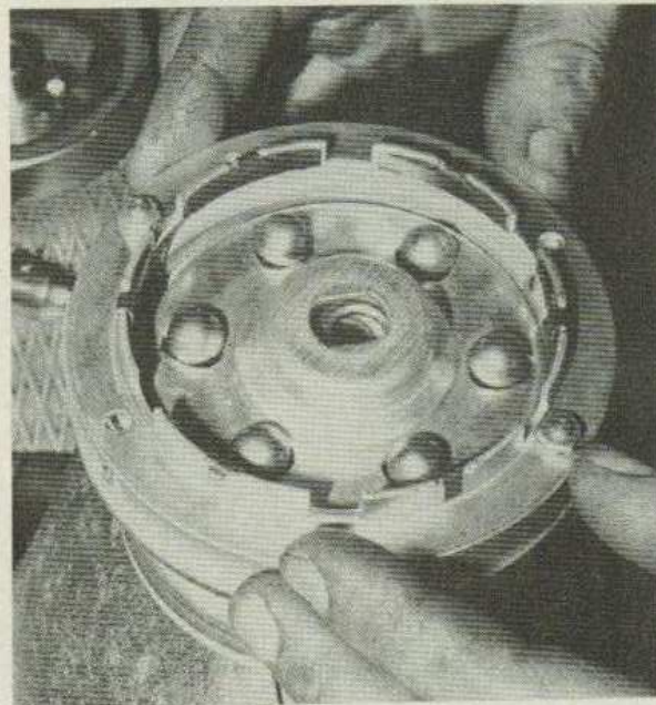
Montage des billes à l'empilage des pièces sur l'établi (Photo RMT)
