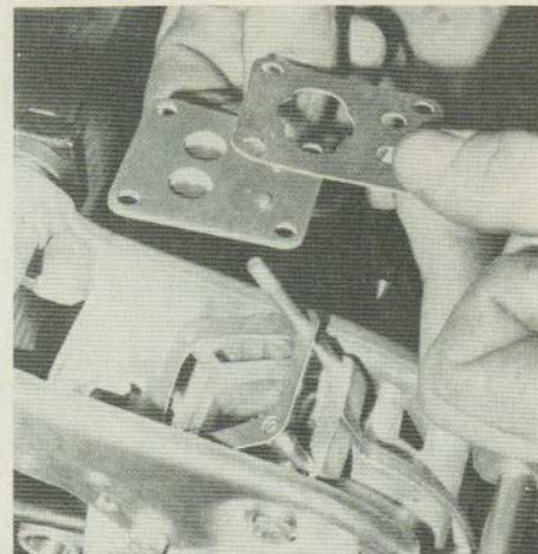
Remontage du clapet avec ses joints inférieur et supérieur qui sont différents (Photo RMT)
