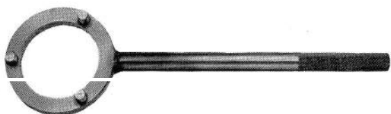
Levier à ergots pour maintenir le couvercle d'embrayage
